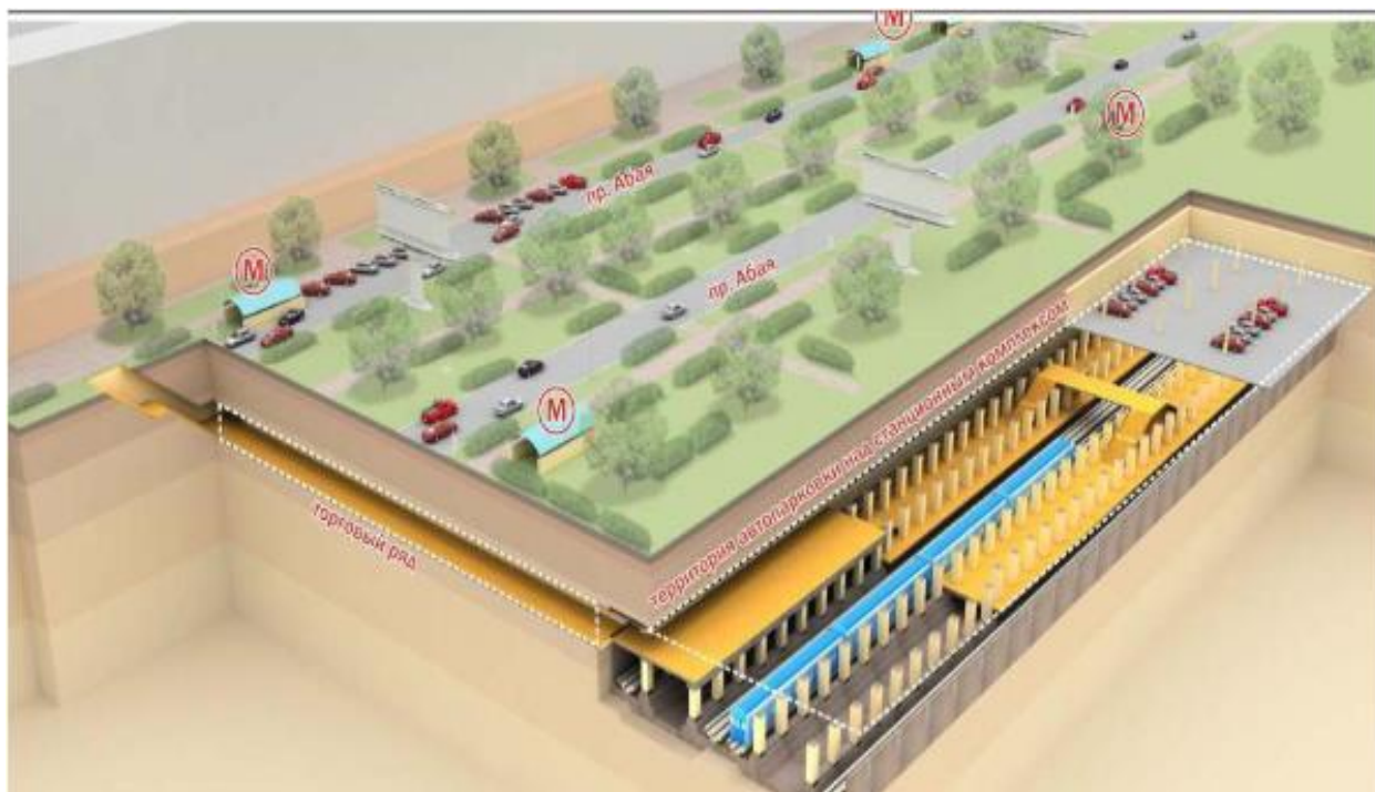
16-сурет – Жетекші бекіткіші бар станцияны салу технологиясының схемасы
