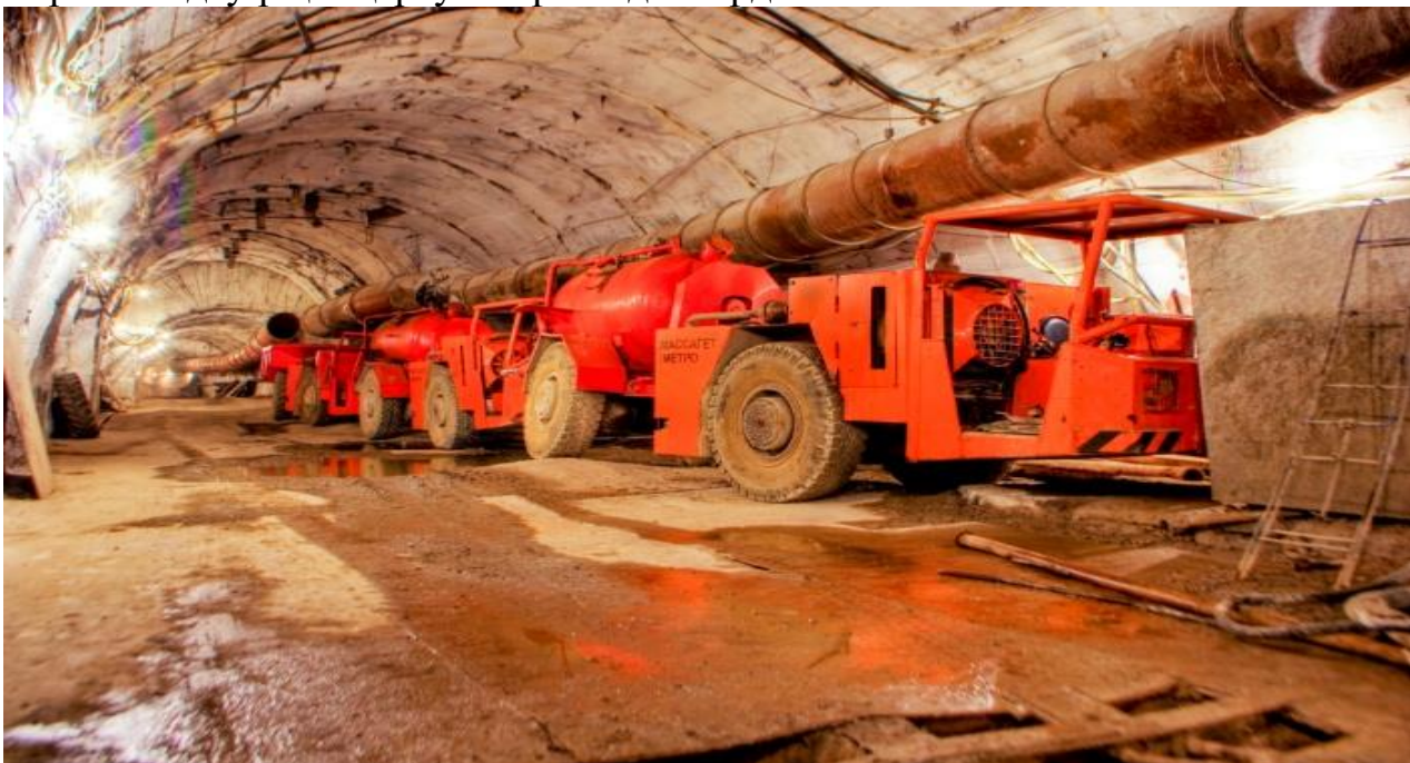
15-сурет – ТСШ - 4б базасындағы бетон тасымалдау машинасы
